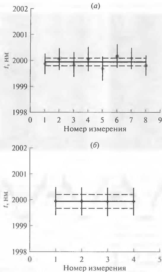
Рис. 12. Результаты определения шага  $t$  виртуальной структуры первым (а) и вторым (б) методами, полученные при обработке сгенерированного высоковольтного ВМЭ изображения, представленного на рис. 11а.
