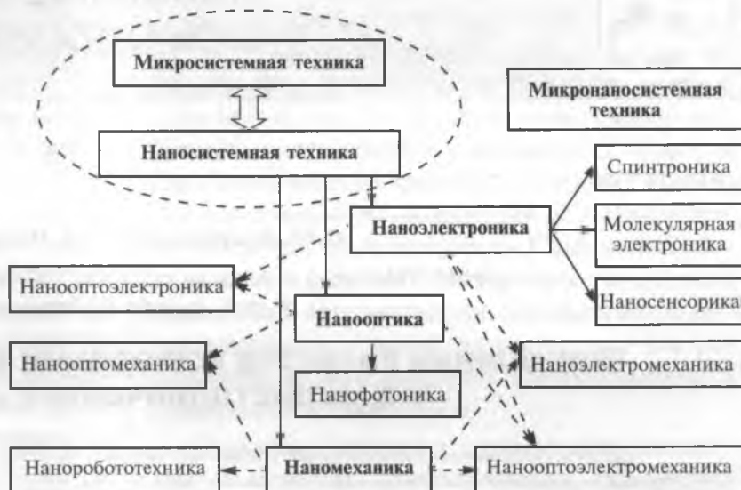
Рис. 3. Классификация видов наносистемной техники по функциональному назначению [10]
