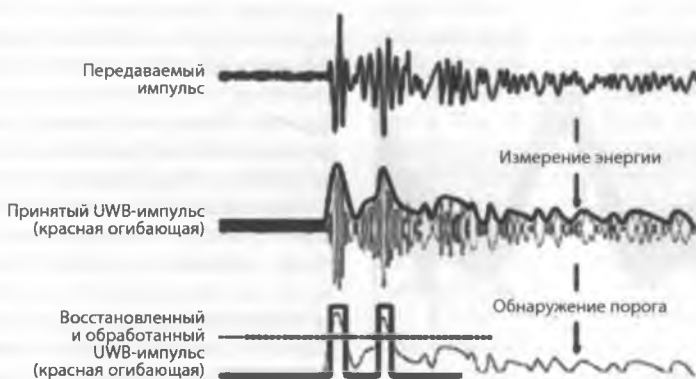
Рис. 5. Некогерентный способ детектирования
