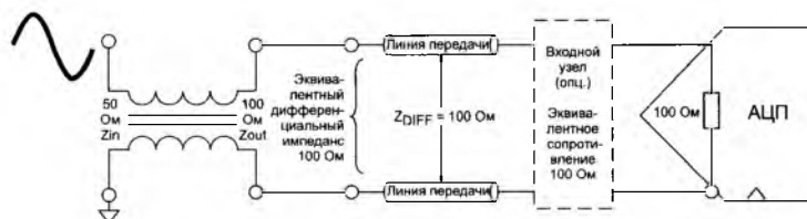
Рис. Дифференциальную линию передачи необходимо согласовать со 100-Ом входным импедансом АЦП и 100-Ом выходным импедансом согласующего трансформатора
