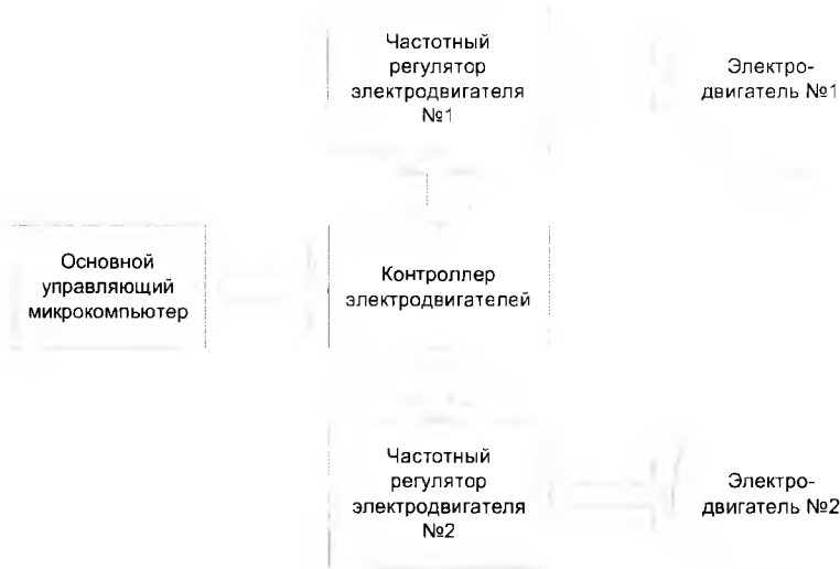
Рис. 1. Классическая реализация системы управления двухдвигательным электроприводом
