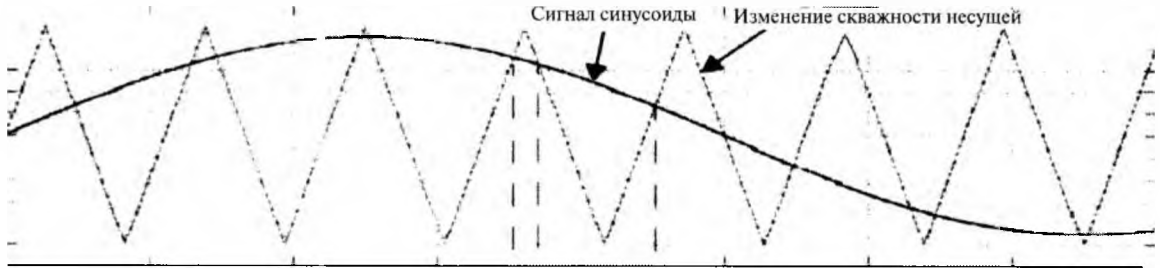
Рис. 3. Генерация синусоидальных колебаний с помощью ШИМ
